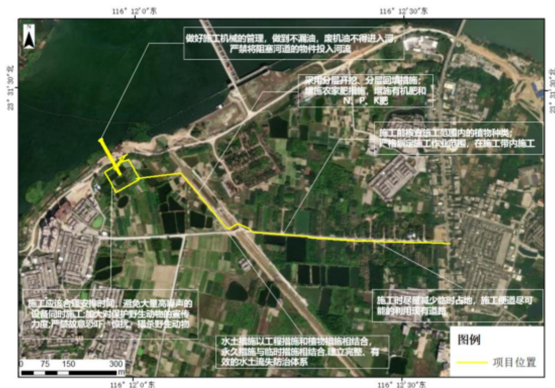
图 6.1-1 施工期典型生态保护措施平面图
