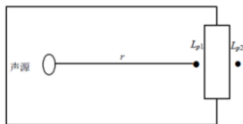
图 5.3-1 室内声源等效为室外声源图例
