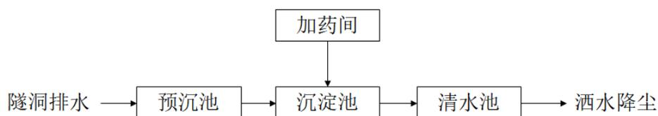
图 7.3.1-2 洞室排水处理工艺流程图
