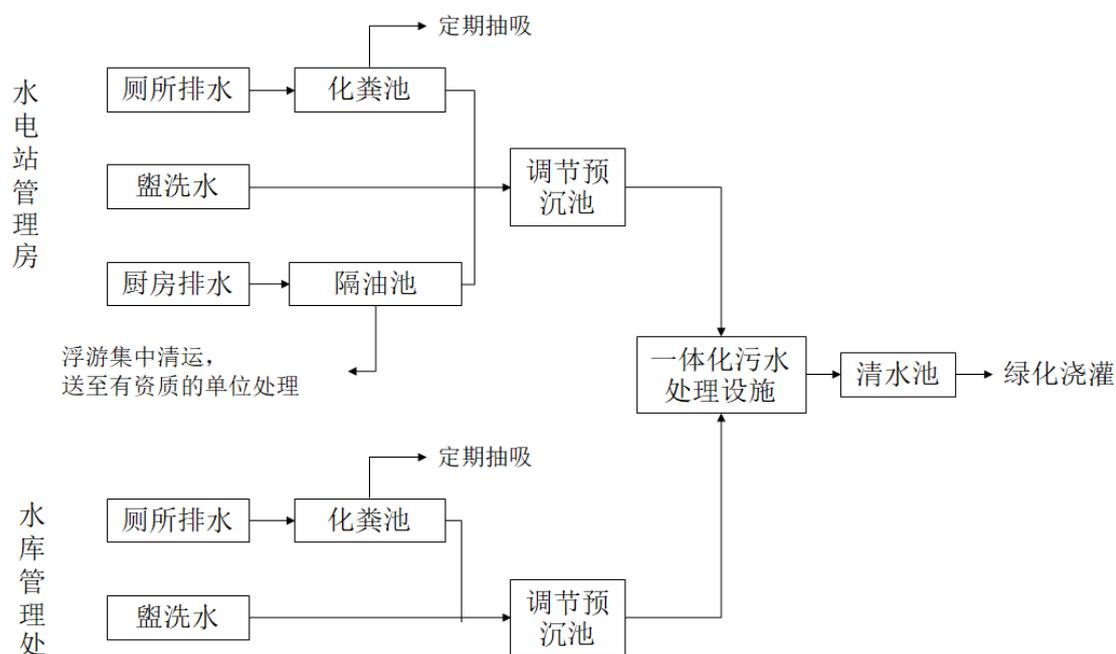
图 7.4.1-1 生活污水处理工艺流程图
