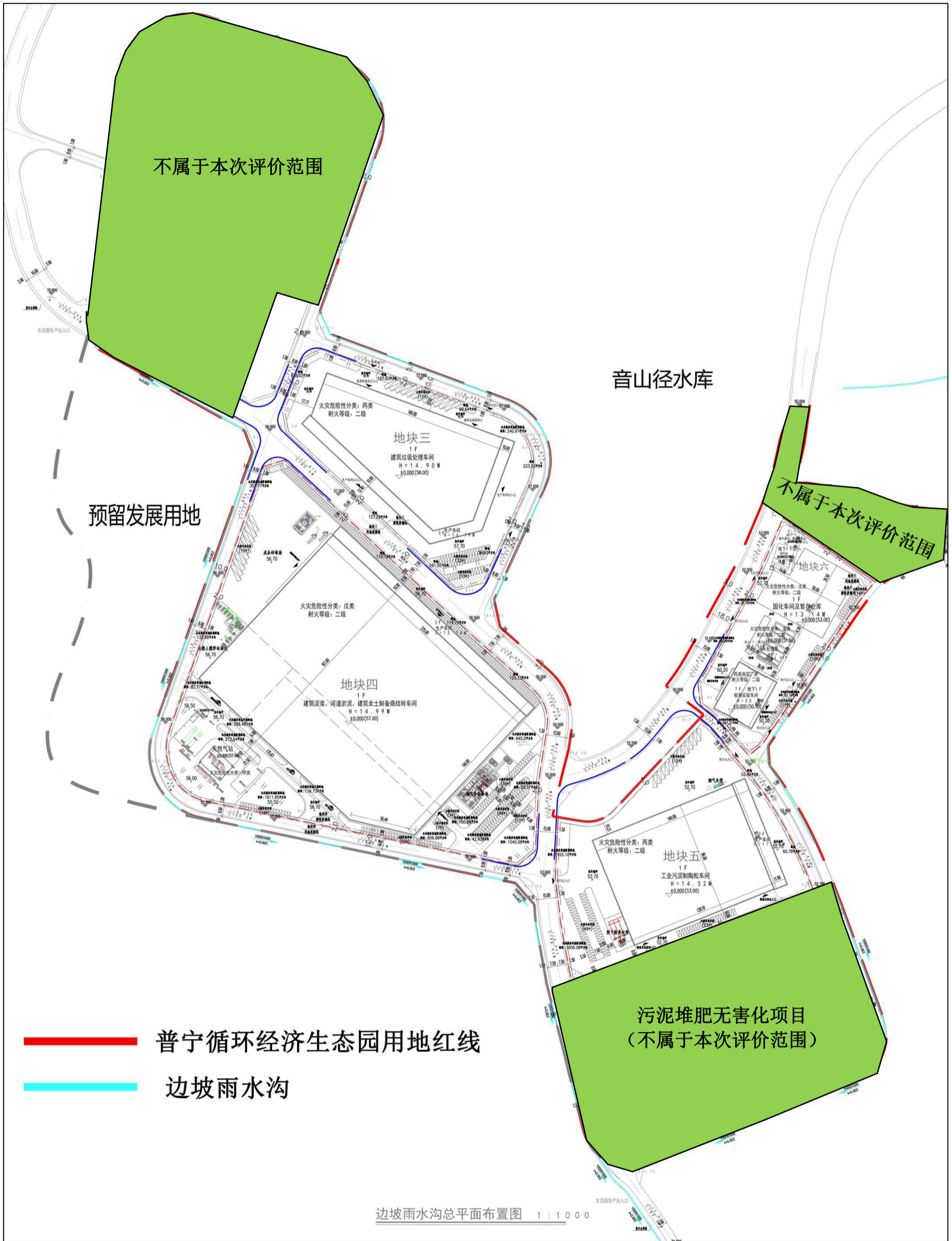
附图 6 (2-2) 本项目雨水管网图
