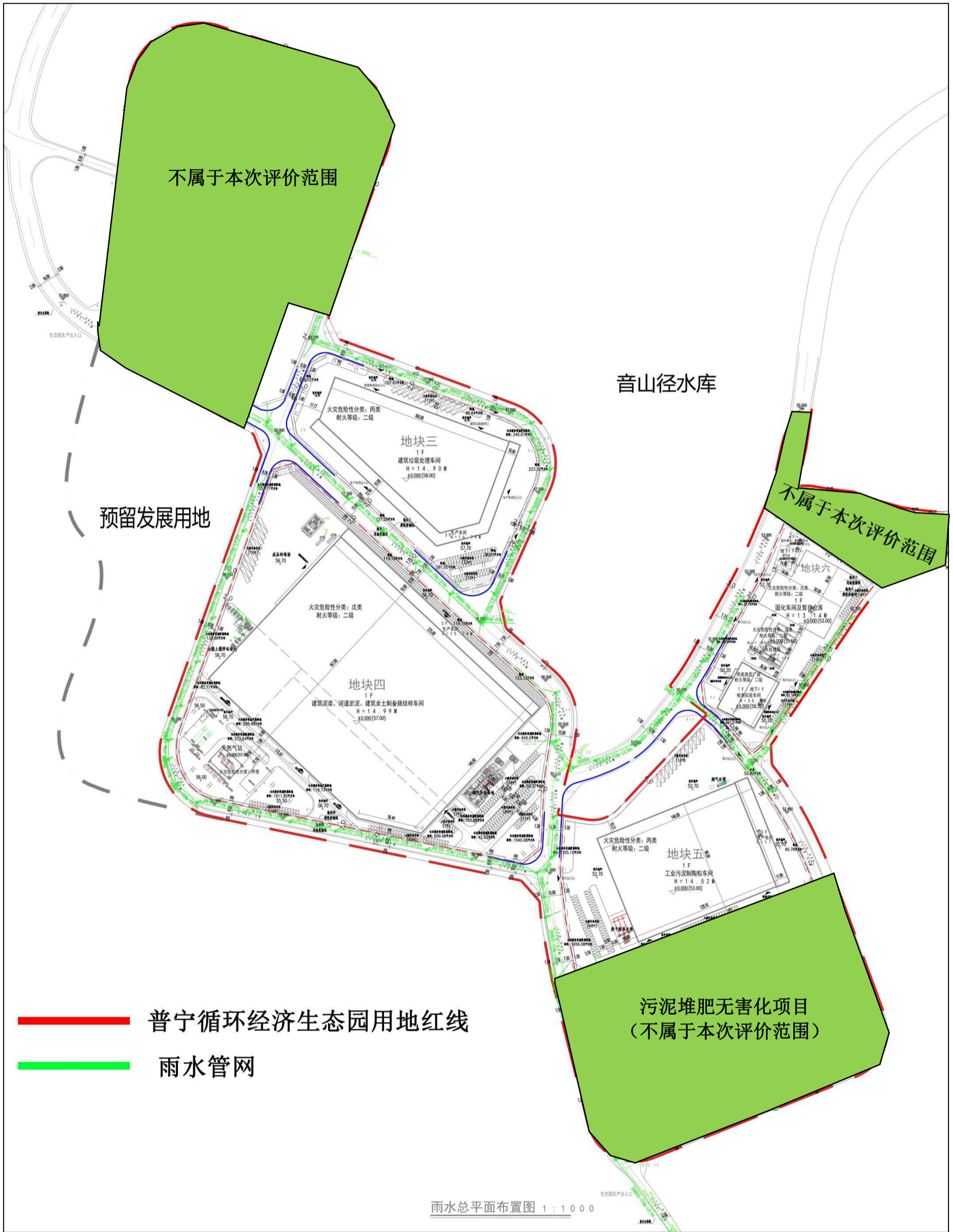
附图 6 (2-1) 本项目雨水管网图
