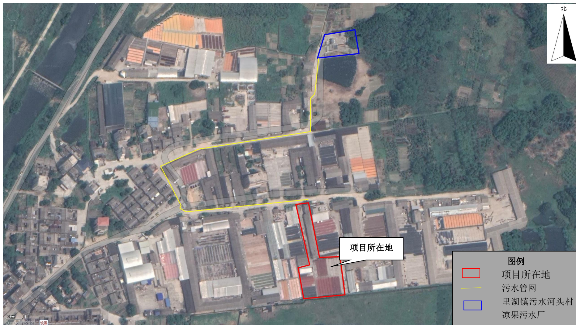
附图 12 纳污水厂的污水管网图
