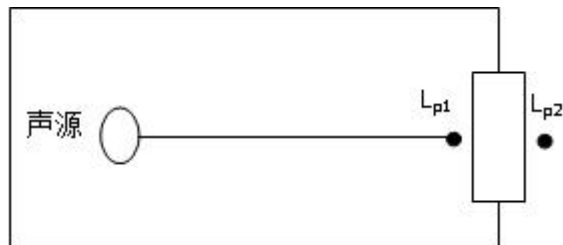
图4-1室内声源等效为室外声源图例
