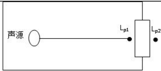
图4-1室内声源等效为室外声源图例
