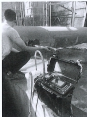
锅炉废气处理后检测口 (DA003) /Q1
