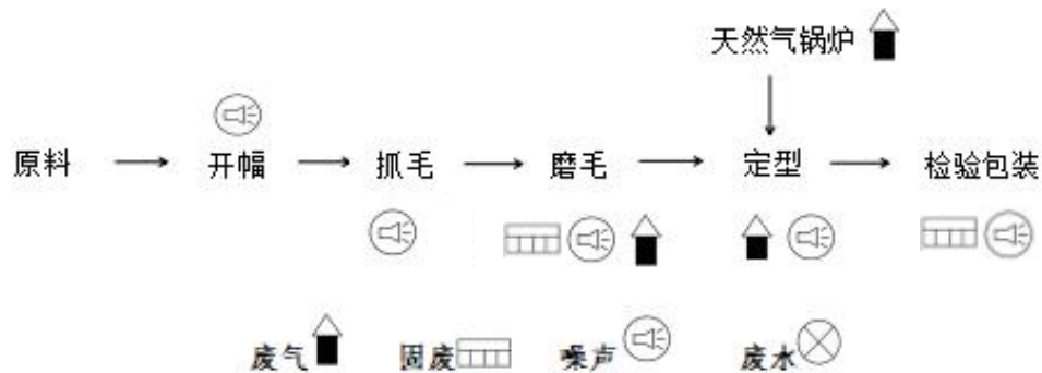
图 2-2 扩建前项目生产工艺流程
