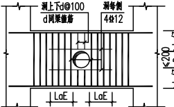
图8.5c 连梁中部圆形洞口补强钢筋构造
