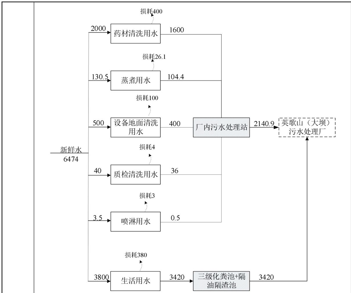
图 2-2 项目水平衡图 (单位 t/a)
