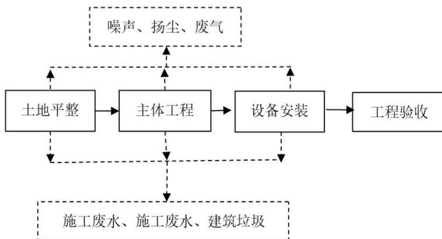
图 2-2 项目施工流程及产污节点图
