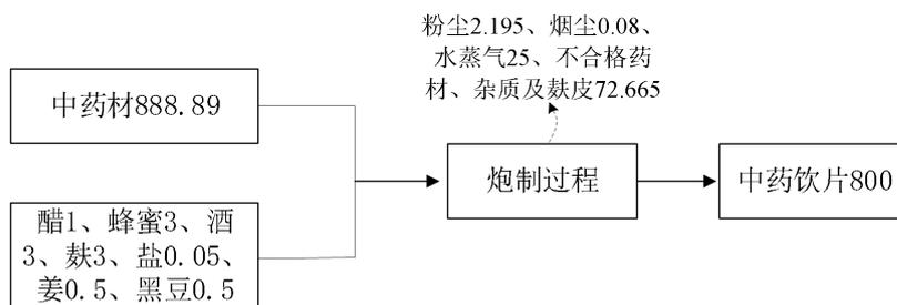
图 2-1 项目物料平衡图 (单位 t/a)
