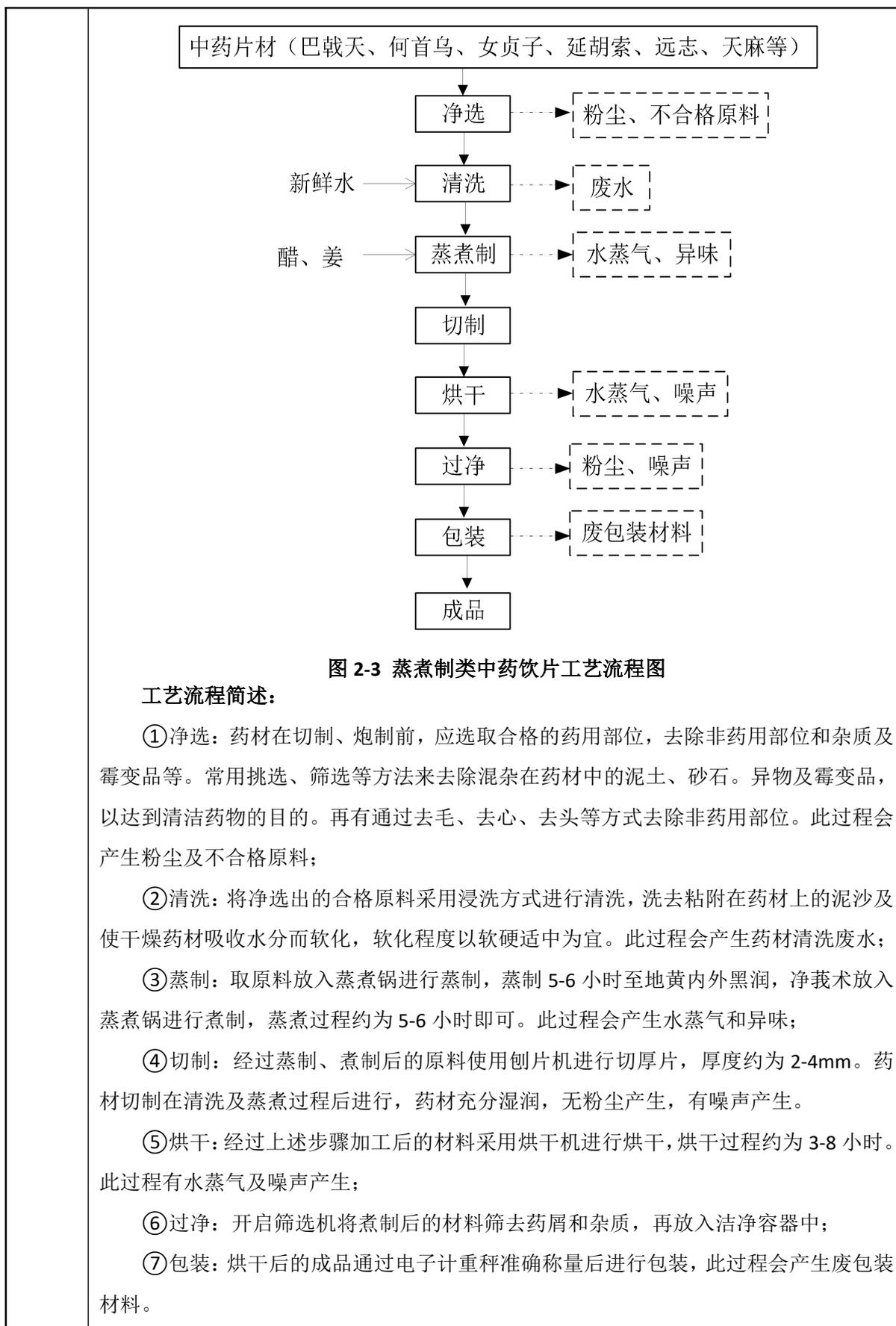
图 2-3 蒸煮制类中药饮片工艺流程图
