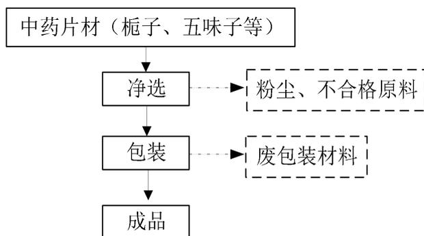
图 2-2 净制类中药饮片工艺流程图
