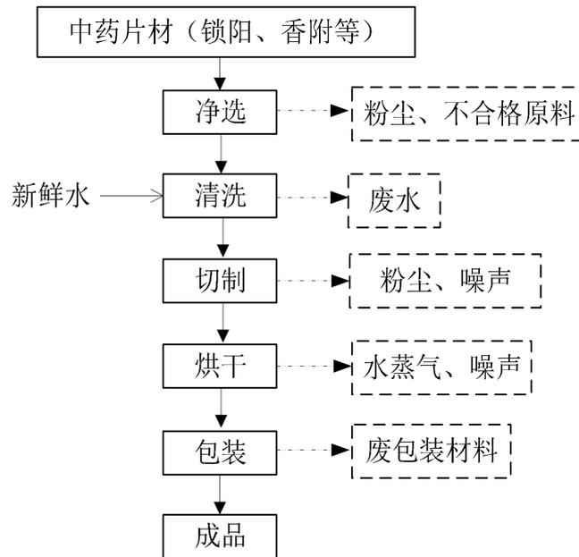
图 2-4 切制类中药饮片工艺流程图
