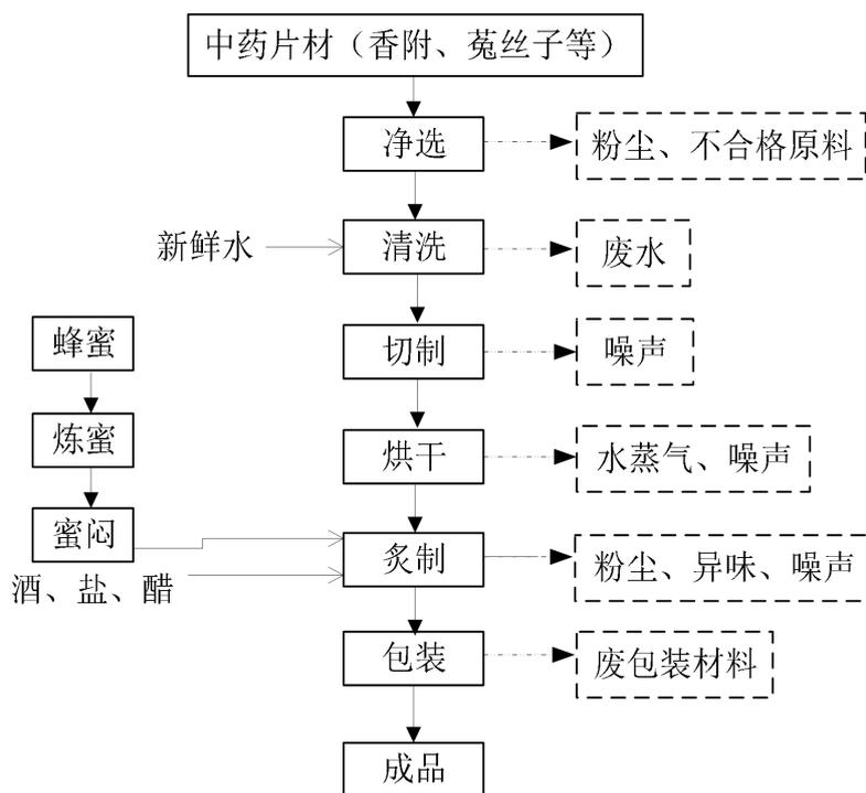
图 2-6 炙制类中药饮片工艺流程图
