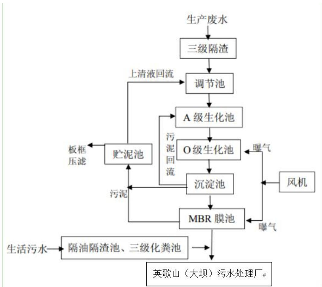
图 4-1 污水处理工艺流程图
