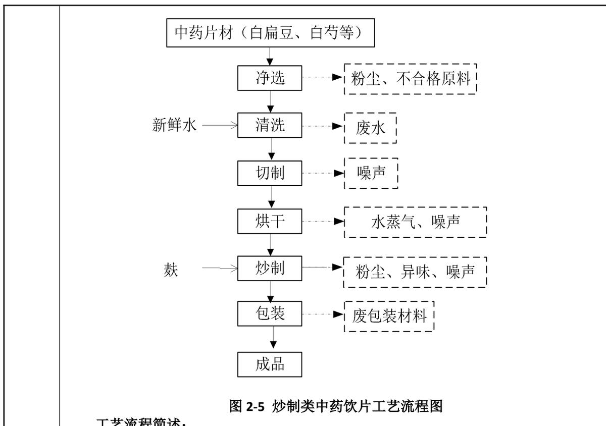
图 2-5 炒制类中药饮片工艺流程图
