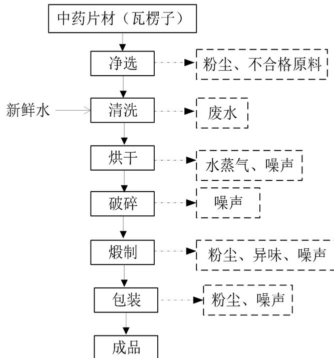
图 2-7 煨制类中药饮片工艺流程图
