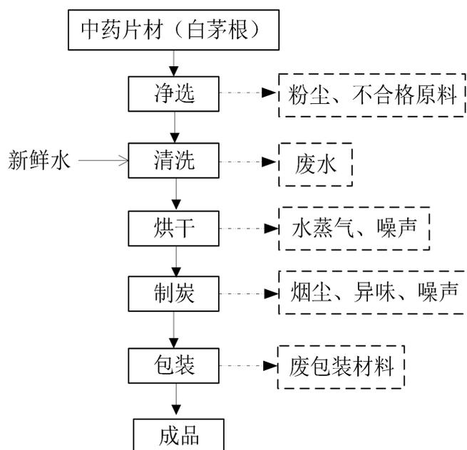
图 2-8 制炭类中药饮片工艺流程图
