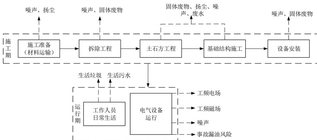
图 2-1 工艺流程及产污环节图
