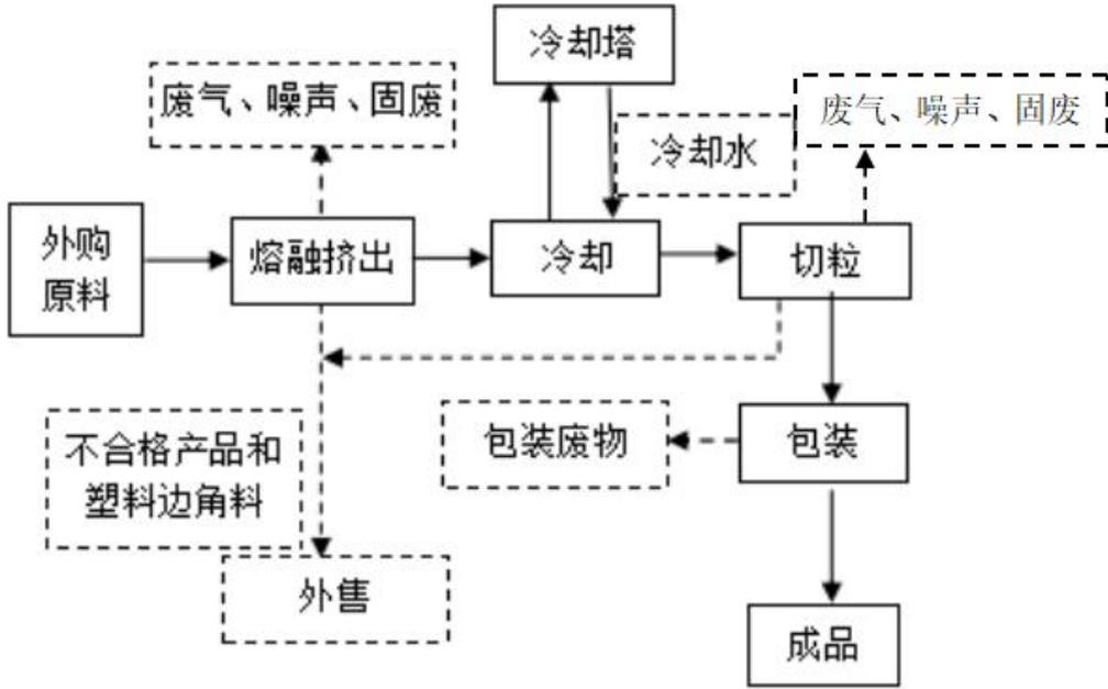
**图 2-2 项目生产工艺流程及产排污环节图**
