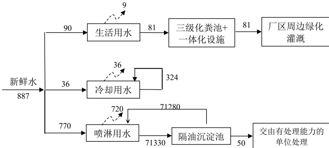
图 2-1 项目水平衡图（单位： $\text{m}^3/\text{a}$ ）
