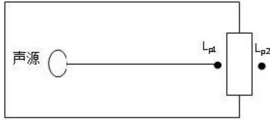
图 4-1 室内声源等效为室外声源图例
