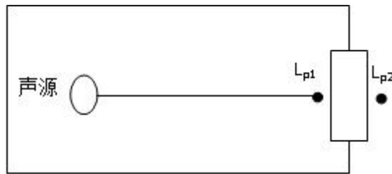
图 4-1 室内声源等效为室外声源图例
