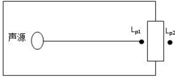
图 4-1 室内声源等效为室外声源图例
