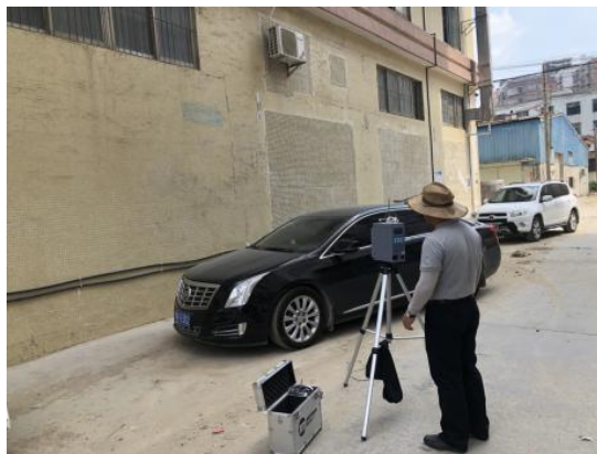
无组织废气现场监测
