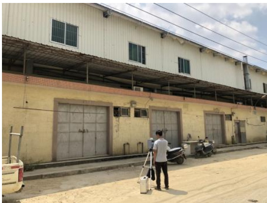
无组织废气现场监测
