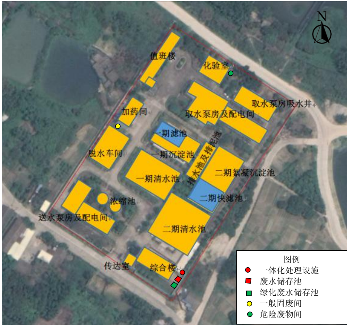
附图3 乌石水厂总平面布置图
