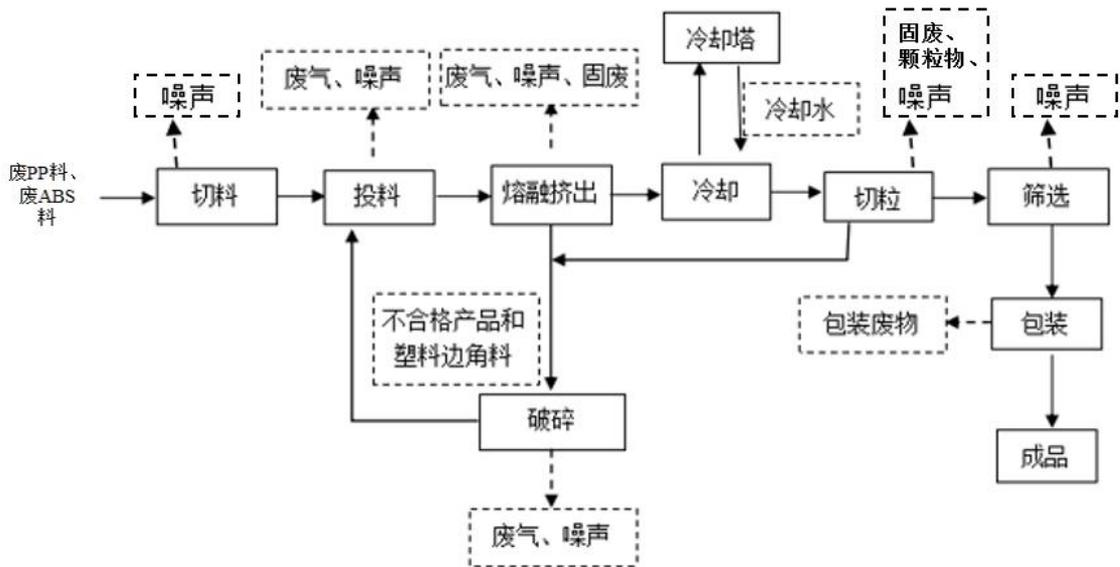
图 2-2 项目生产工艺流程及产排污环节图
