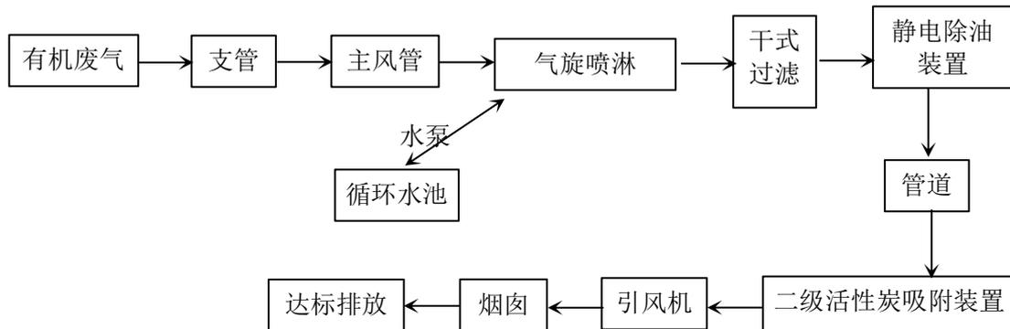
图 4-1 项目废气处理工艺流程图
